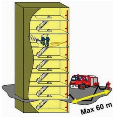
Lorsque le bâtiment est défendu par une colonne sèche et quelle que soit la distance de référence préconisée, la distance maximale entre le premier point d'eau d'incendie et les demi-raccords de la colonne sèche devra être **au plus de 60 mètres**.
