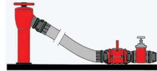
Afin de limiter les perturbations liées à l'écoulement de l'eau, positionner un tuyau de Ø 100 mm d'une longueur minimale de 5 mètres, entre l'hydrant et l'appareil de mesure.
