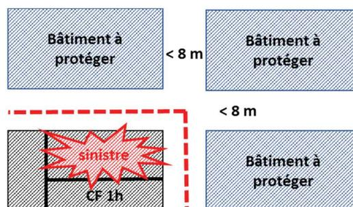
**!** Si la configuration des bâtiments le nécessite, il peut être nécessaire d'ajouter plusieurs lignes de défense successives afin de déterminer la ligne de défense à réaliser. (cf. cas n°2 et n°3)
