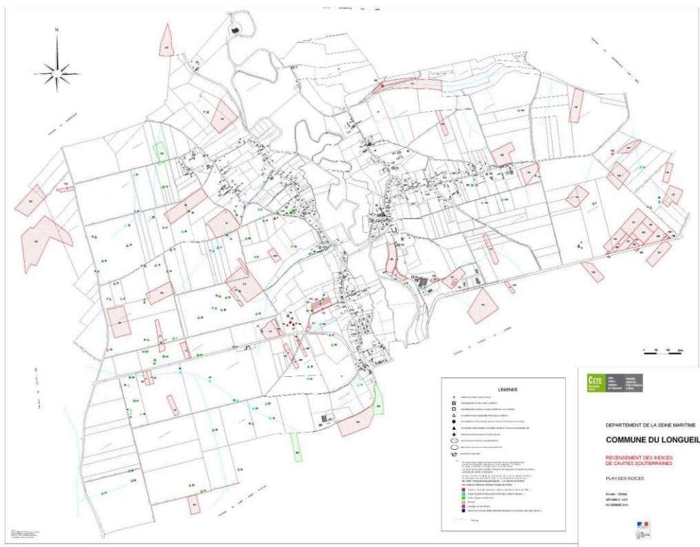
Figure 4 : Recensement des indices de cavités souterraines sur le territoire communal de Longueil
