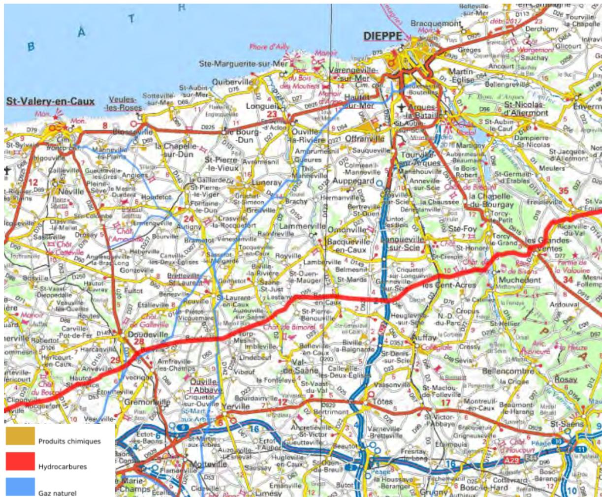
Figure 96 : Canalisations de transport de matières dangereuses (Source : Géorisques)
