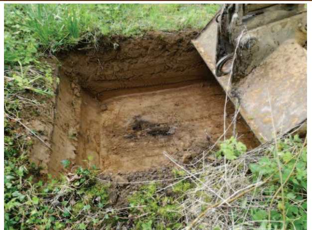
Photographie 8 : Disparition progressive de la terre noirâtre au profit de limon de remblais
