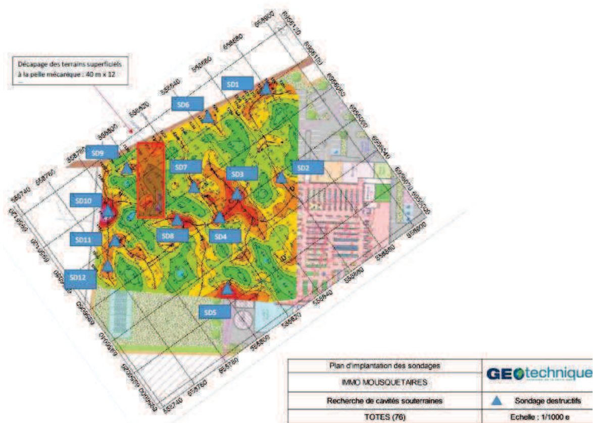
Figure 9 : Cartographie du décapage et des forages menés par Géotéchnique lors de la phase 2
