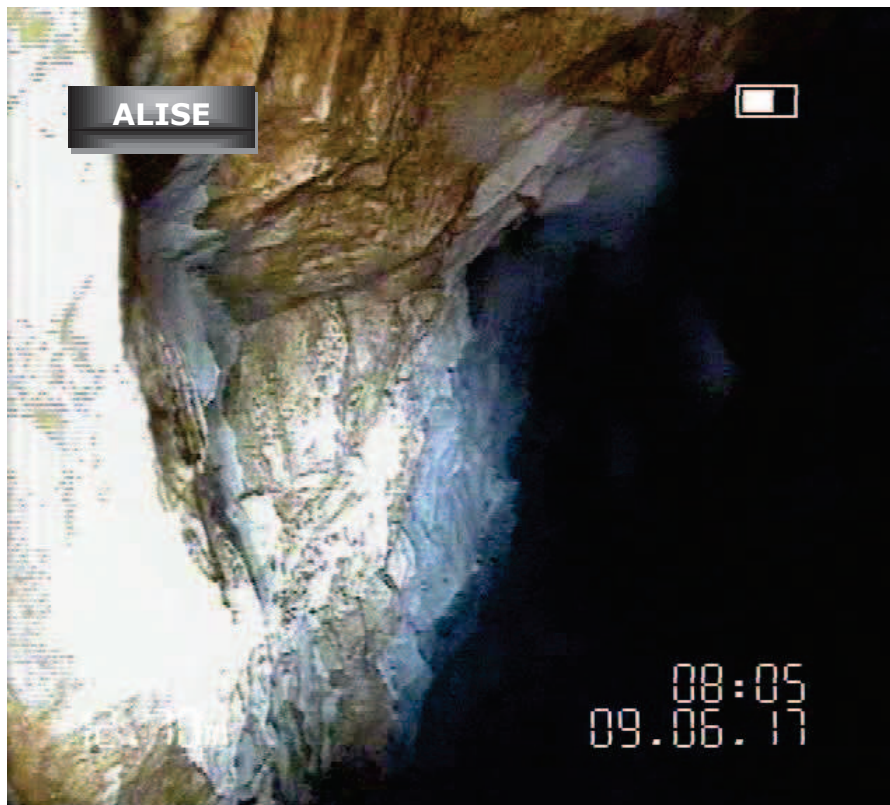
Passage caméra dans le forage SD2 de l'indice n°163 : confirmation de la galerie
