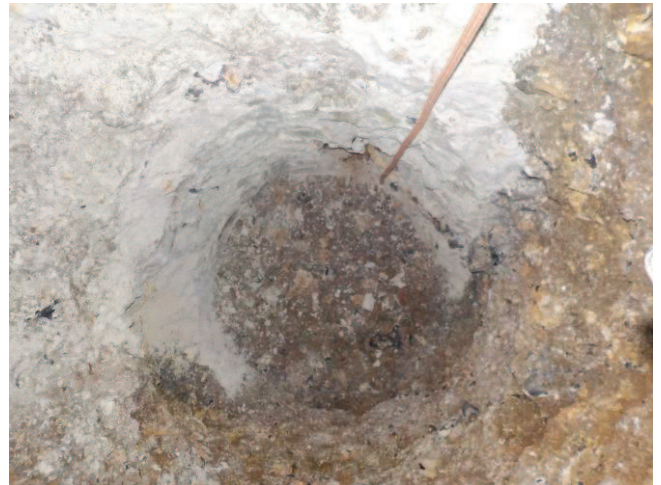
Photographie 4 : Puits avorté, fond du puits recreusé dans la marne sans exploitation de matériaux
