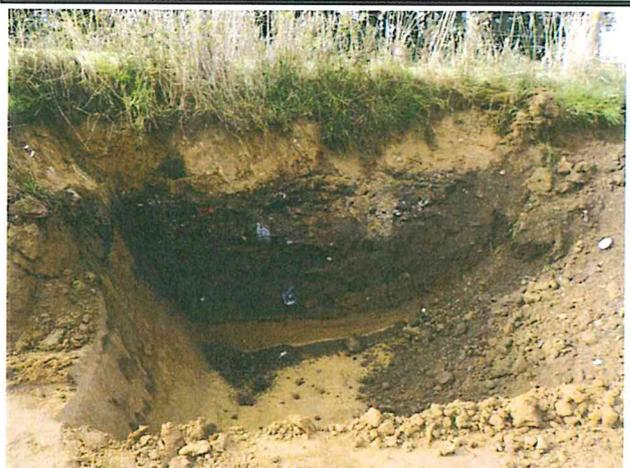
**Photographie 10 : Zone de remblais (1/3) composée de cendre, briques, déchets plastiques...**
