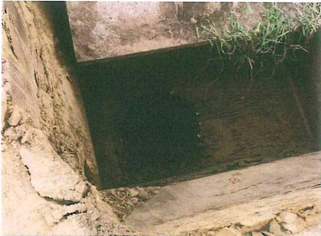
**Photographie 7 : Puits de marnière (situé à proximité de l'indice 123), limon brun foncé au sein du limon jaune**
