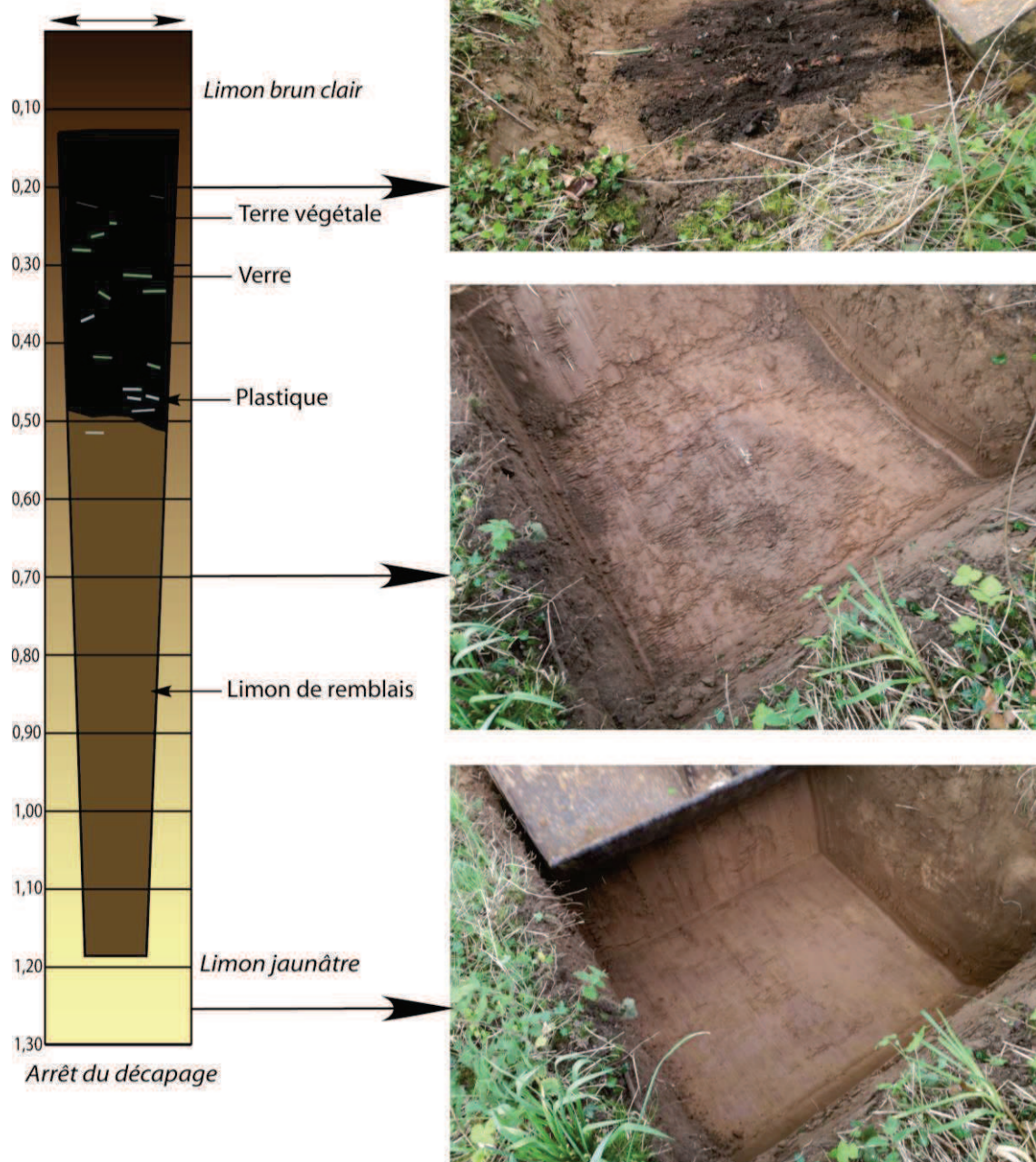
Figure 2 : Coupe synthétique des formations rencontrées (cuvette nord-est)
