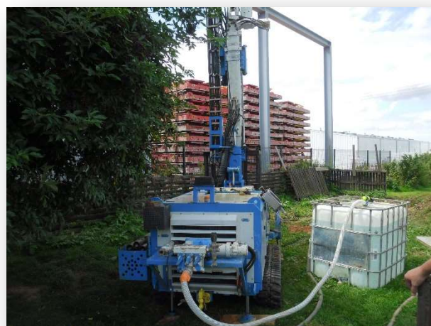
Foreuse EMCI 7.50 sur chantier
