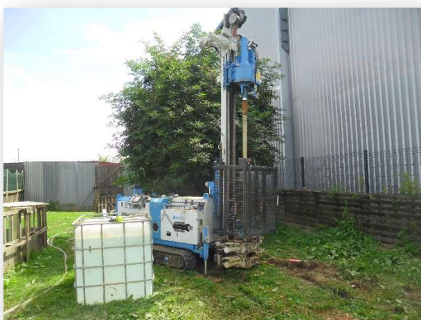
Foreuse EMCI 7.50 sur chantier
