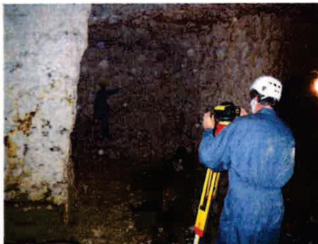
Photographie 1 : exemple de relevé dans une cavité souterraine
