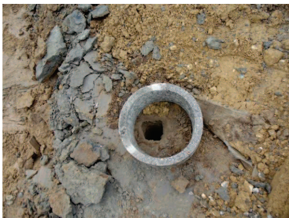
Photographie 5 : Trace d'un ancien forage
