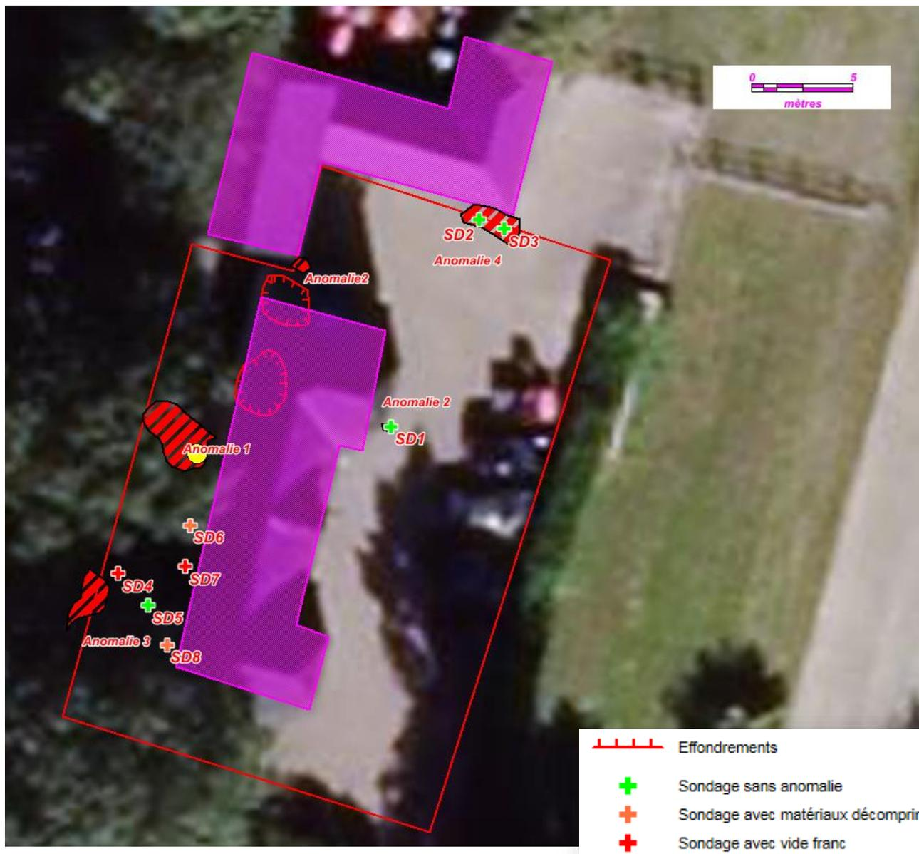
La présence du même plancher franc à environ -8,00m/TN que lors des sondages de la première phase d'investigation a permis de confirmer que les SD4, SD6, SD7 et SD8 ont rencontré une continuité d'exploitation de l'établissement souterrain.
