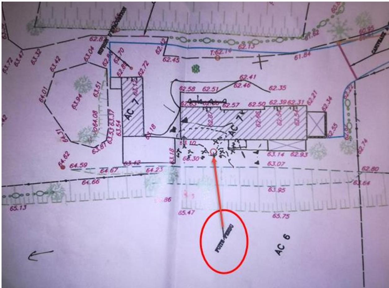
Bien que non situé là où il est figuré sur le plan, un puits maçonné avait été découvert de manière fortuite au droit de SD09. Ce sondage avait recoupé une dalle béton avant de déboucher dans l'ancien puits.
