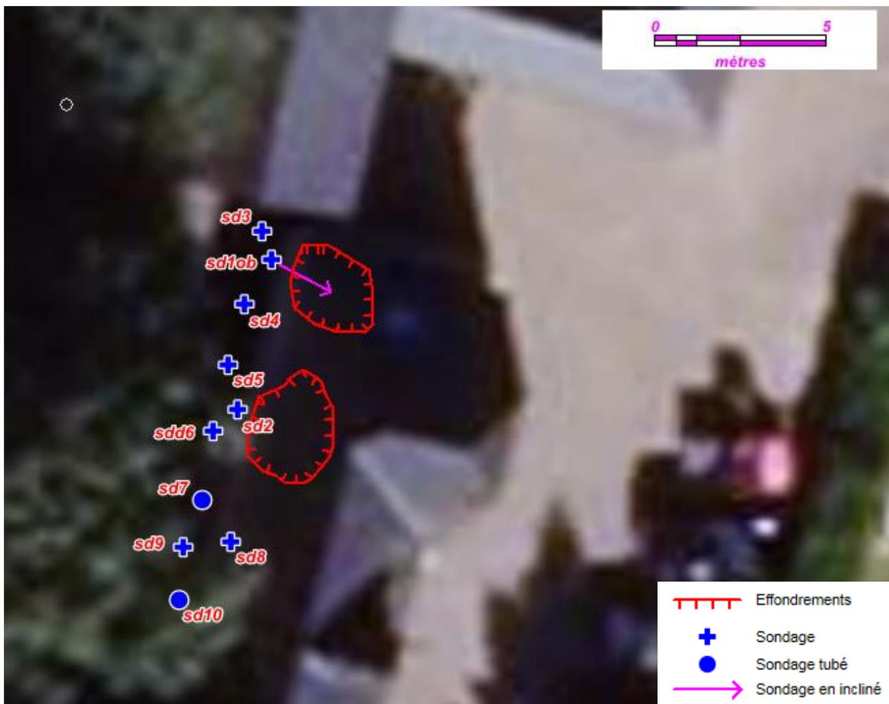
Le Sondage (SD1) a été réalisé en incliné (11° d'angle) afin de recouper l'effondrement et reconnaître le plancher de l'anomalie.
