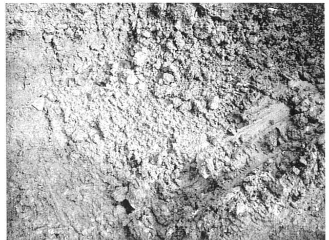
**Photographie 6 : Continuité des remblais au sein de l'argile à silex (arrêt du décapage à 2,5m)**
