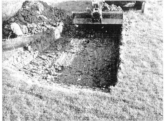
**Photographie 2 : Dès 0,5 m apparition d'une anomalie (déchets) au sein des limons**
