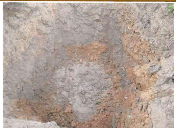
**Photographie 4 : Fin de décapage : limon grisâtre encaissé au sein de l'argile à silex en place (2.6m de profondeur)**
