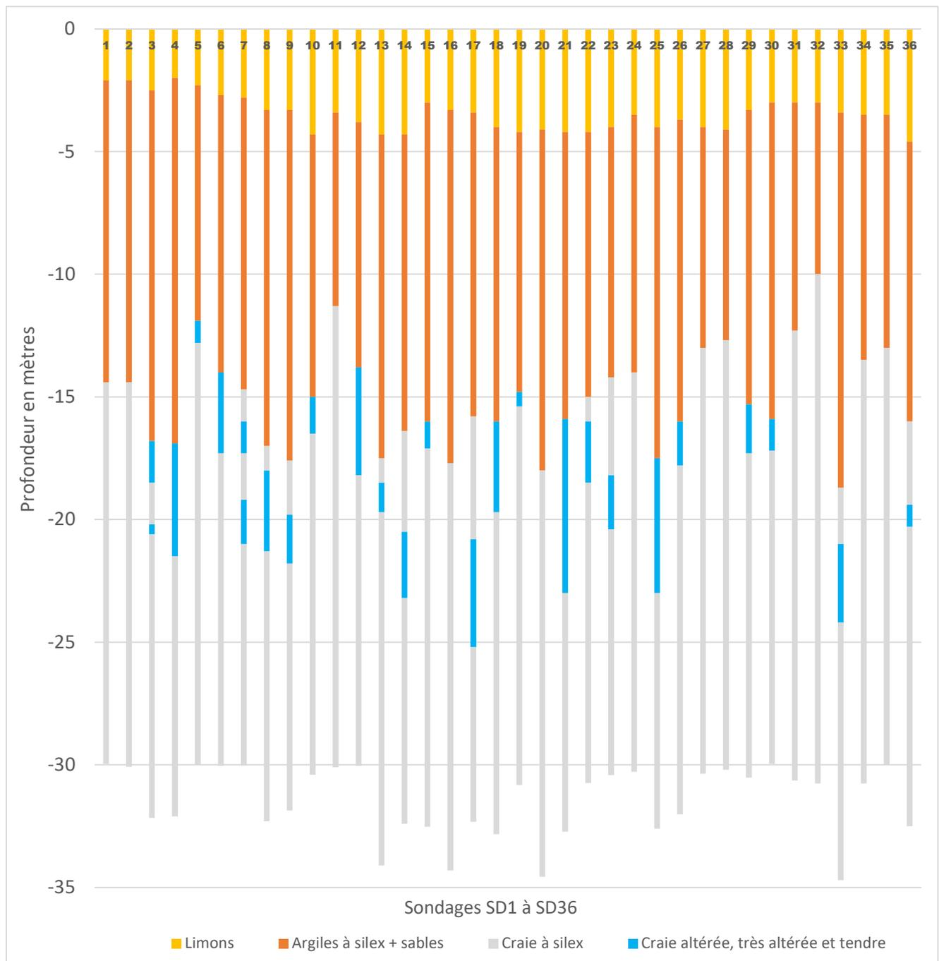
**Représentation schématique du sous-sol avec les anomalies (SD1 à SD36)**
