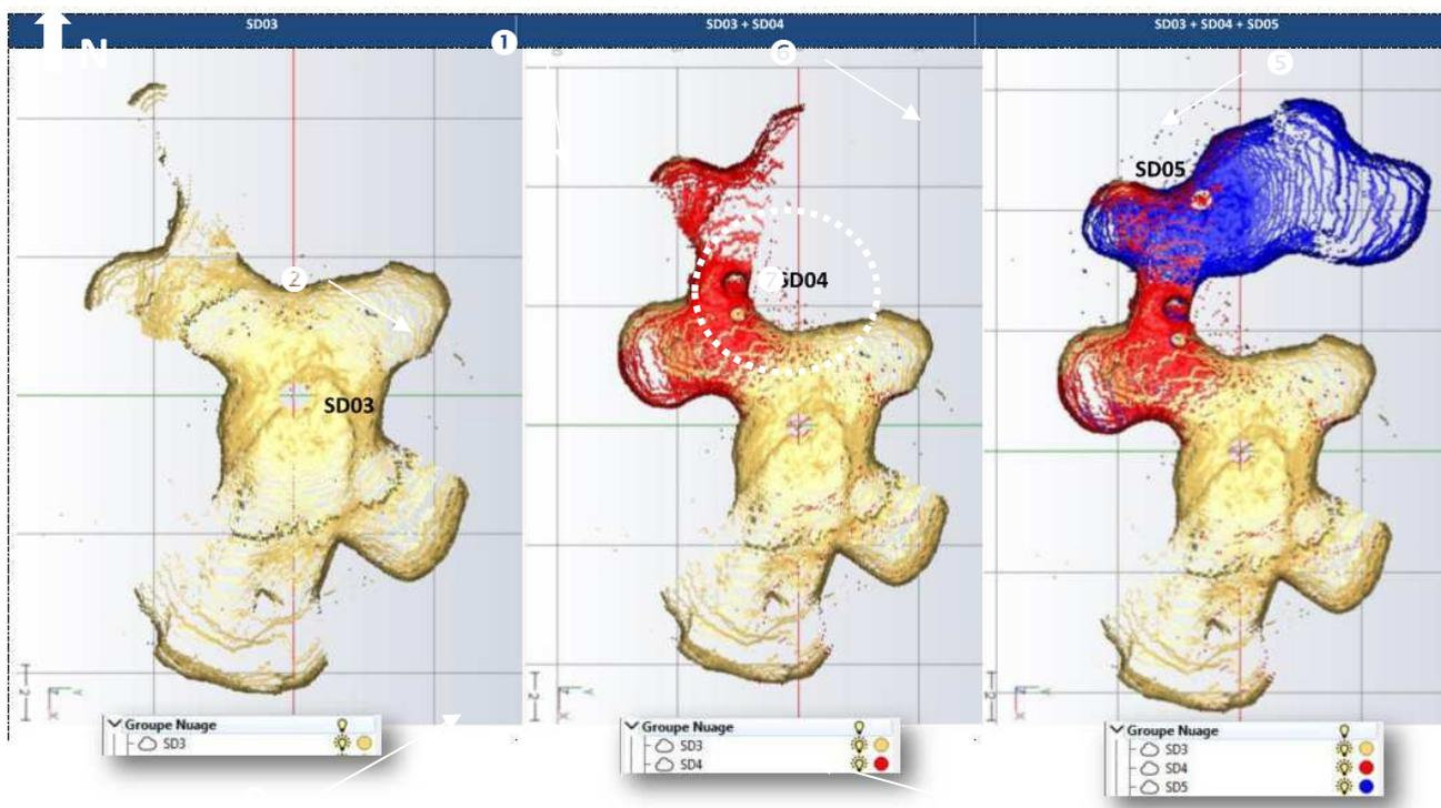
Vue sur un assemblage de 3 nuages de points acquis au droit de 3 sondages différents et permettant une cartographie intégrale d'une marnière
