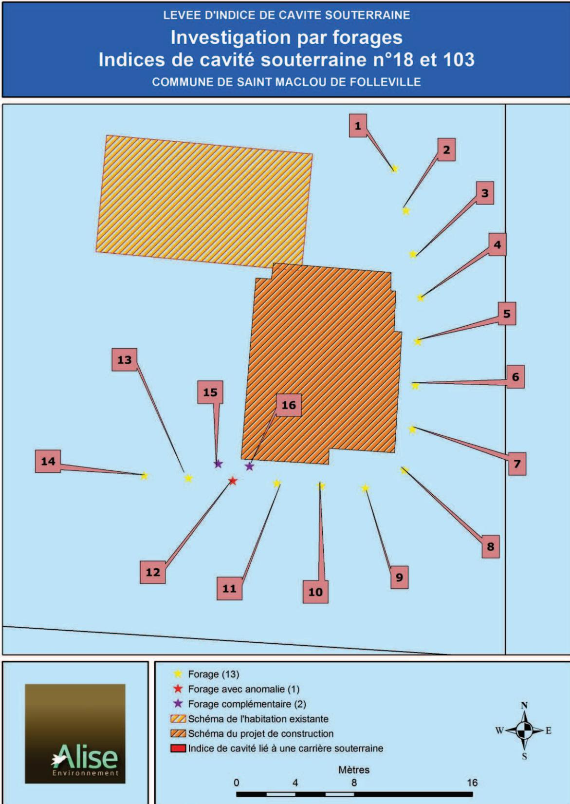
**Figure 8 : Implantation schématique des forages**
