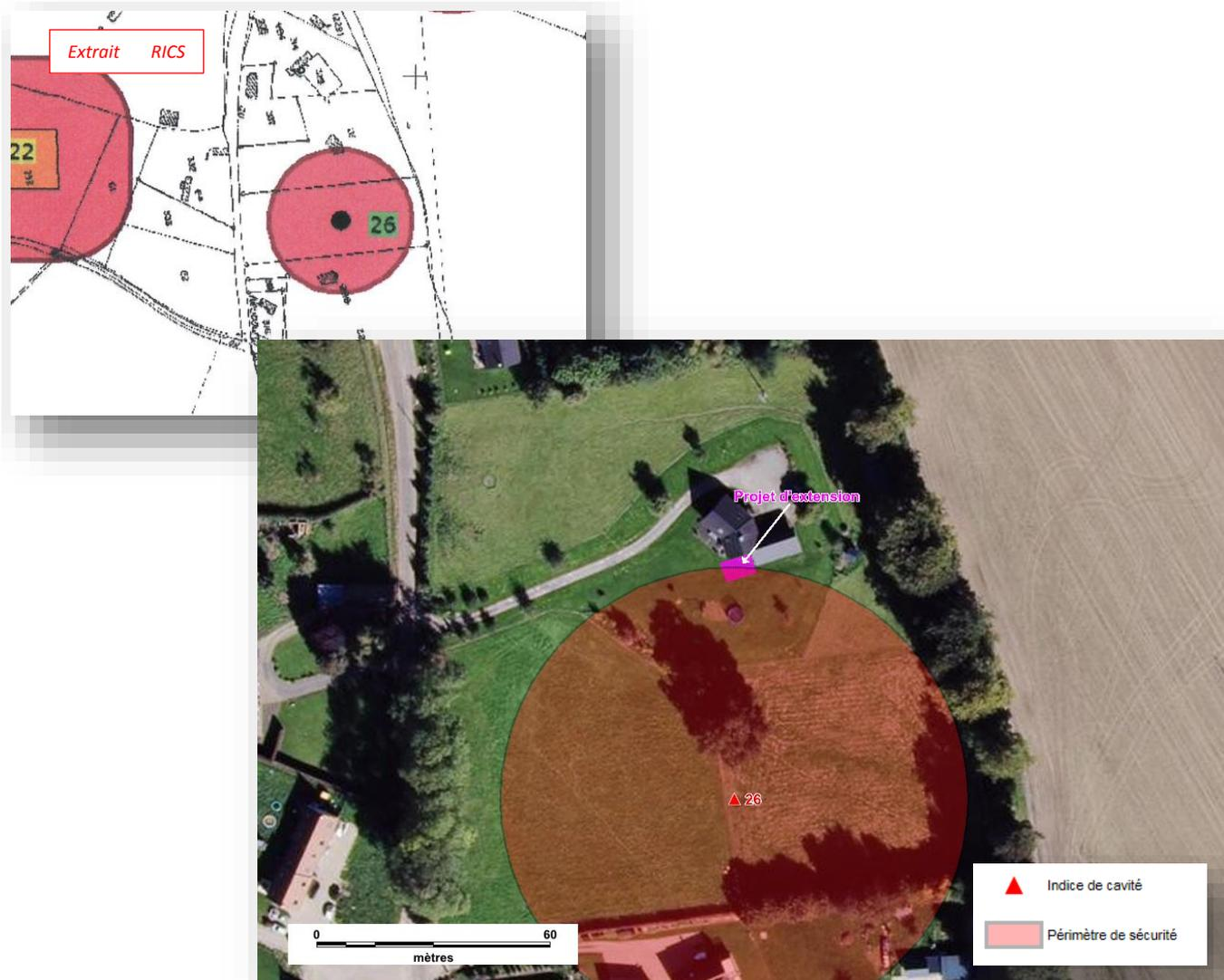
La présente mission a consisté à mettre en œuvre un programme de reconnaissance par sondages destructifs profonds, conforme aux prescriptions des services de la DDTM, destiné à vérifier l'absence de vides souterrains afin d'aménager en conséquence, localement, le périmètre de sécurité lié à l'indice 76574-26 au droit du projet d'extension de l'habitation existante.
