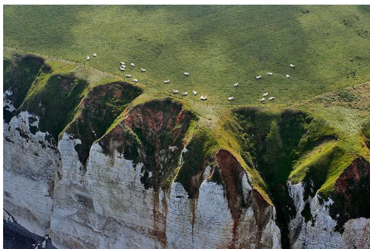
Vue aérienne de la falaise côtière on notera le "festonnage" lié à la succession de points durs (pinacles de craie) et de racines remplies de matériaux résiduels moins compacts
