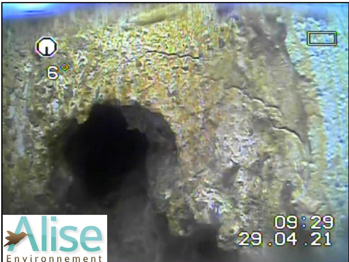
**Photographie 7 : Passage caméra dans SD8. Recroisement d'un petit réseau karstique en forme de serrure.**
