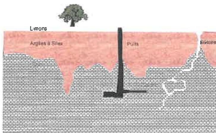
**Figure 1 : Coupe géologique schématisant une exploitation souterraine de matériaux et une « bétoire »**
