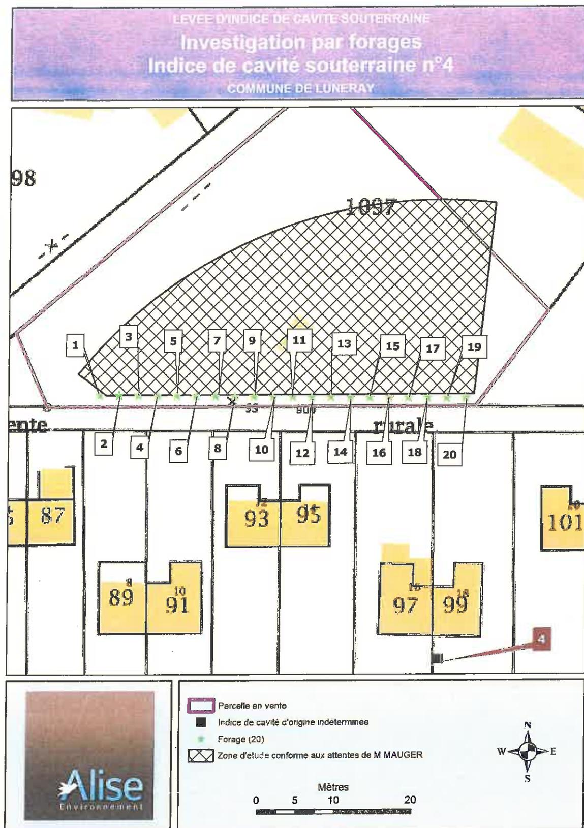
**Figure 8 : Implantation schématique des forages**
