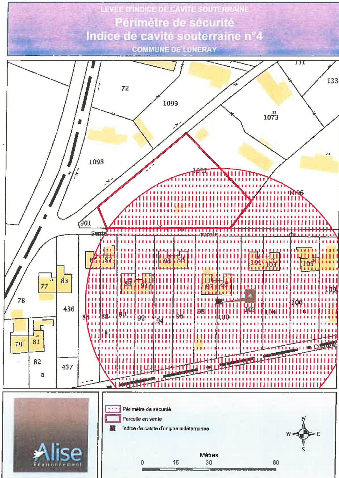
**Figure 4 : Périmètre de sécurité avant investigation par forages**
