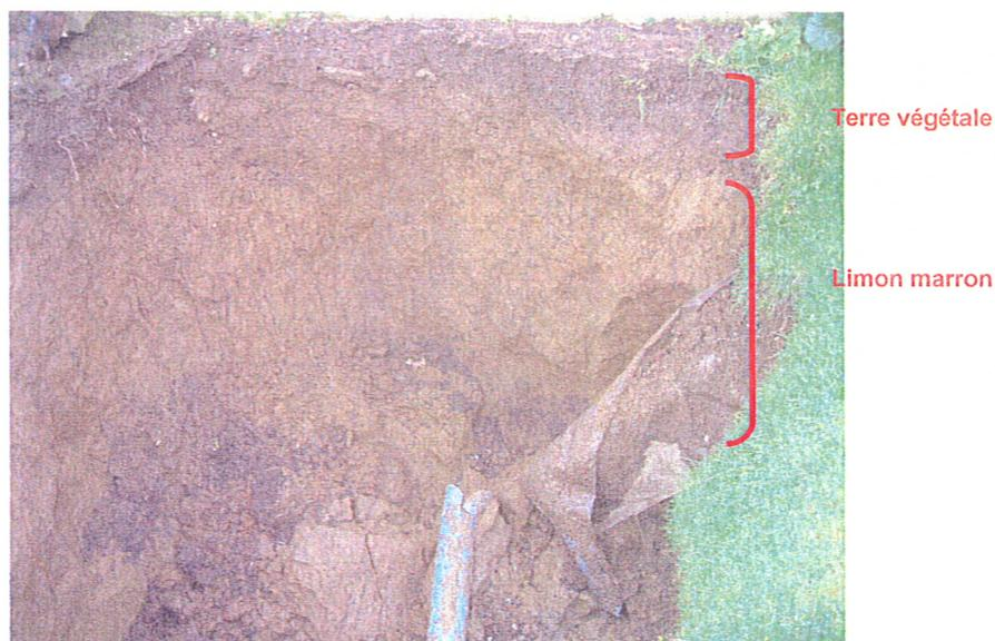
Figure 3 : Vue rapprochée des parois de l'effondrement
