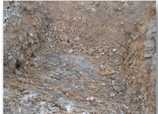
***Anomalie 2 : anomalie circulaire observée à 0,4 mètre de profondeur et mélange de terrains observé en fond de fouille***
