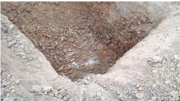
**Photographie 13 : Retour à une forme circulaire de l'anomalie vers 6m de profondeur. Anomalie composée de limons grisâtres et de morceaux de marne**
