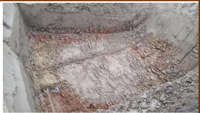
**Photographie 8 : Diamètre de 2m de l'anomalie toujours constant au sein des argiles à silex**
