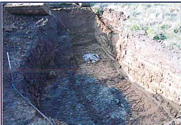
1 effondrement de 3 m de diamètre à 1,9 m de profondeur.
