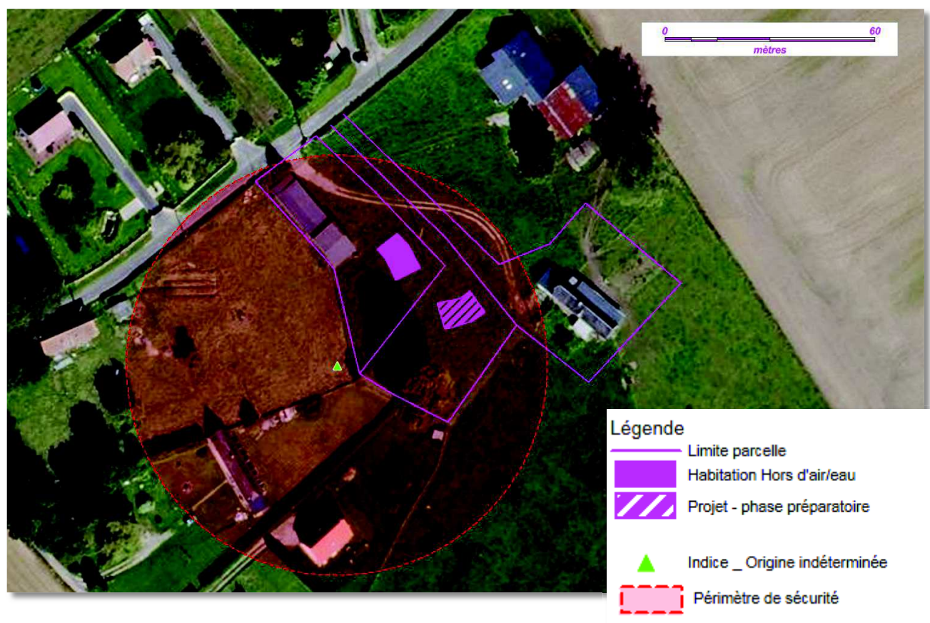
Schéma 3 : Indice de cavité souterraine d'origine indéterminée associé à son périmètre de sécurité - Report sur fond BD Ortho© - © IGN 2017 – www.ign.fr
