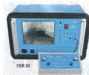
L'une des fonctionnalités fondamentales de cet équipement est de disposer d'une centrale inertielle (IMU associant trois gyroscopes angulaires avec trois accéléromètres orthogonaux et trois magnétomètres orthogonaux) qui permet de garder en mémoire durant toute la phase d'acquisition (dérive donnée par le constructeur à moins de 3°/h) la direction du nord magnétique calée en surface préalablement.
