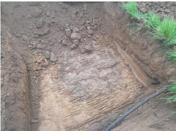
**Photographie 5 : Anomalie circulaire d'1m de diamètre au sein des limons en place à 1m de profondeur**
