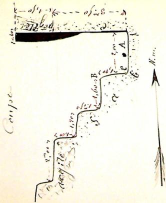
le 13 Mai, le sieur Bureau (un jeune ouvrier carrier, qui travaillait à enlever du sable au point A de vant des terres en suspension de 0,20 fut tout-à-coup surpris par l'éboulement de la paroi en briques, d'un volume de deux mètres cubes environ, qui le couvrit entièrement.
