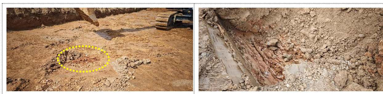
Schéma 7 : Anomalie superficielle liée à l'interface irrégulière entre les limons et les formations résiduelles à silex
