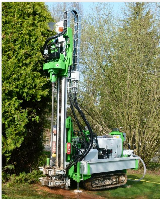
**Les forages ont été réalisés en diamètre 102 mm. Nous rappellerons que le diamètre minimal à mettre en œuvre dans le cadre de la recherche de cavités souterraines afin de respecter les prérogatives des services de l'État est de 89 mm.**
