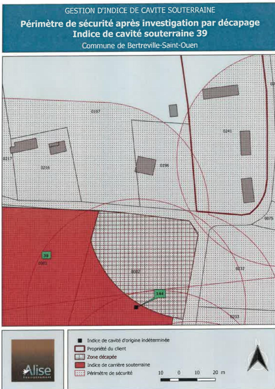
**Figure 8 : Périmètre de sécurité de l'indice 39 après investigations par décapage**
