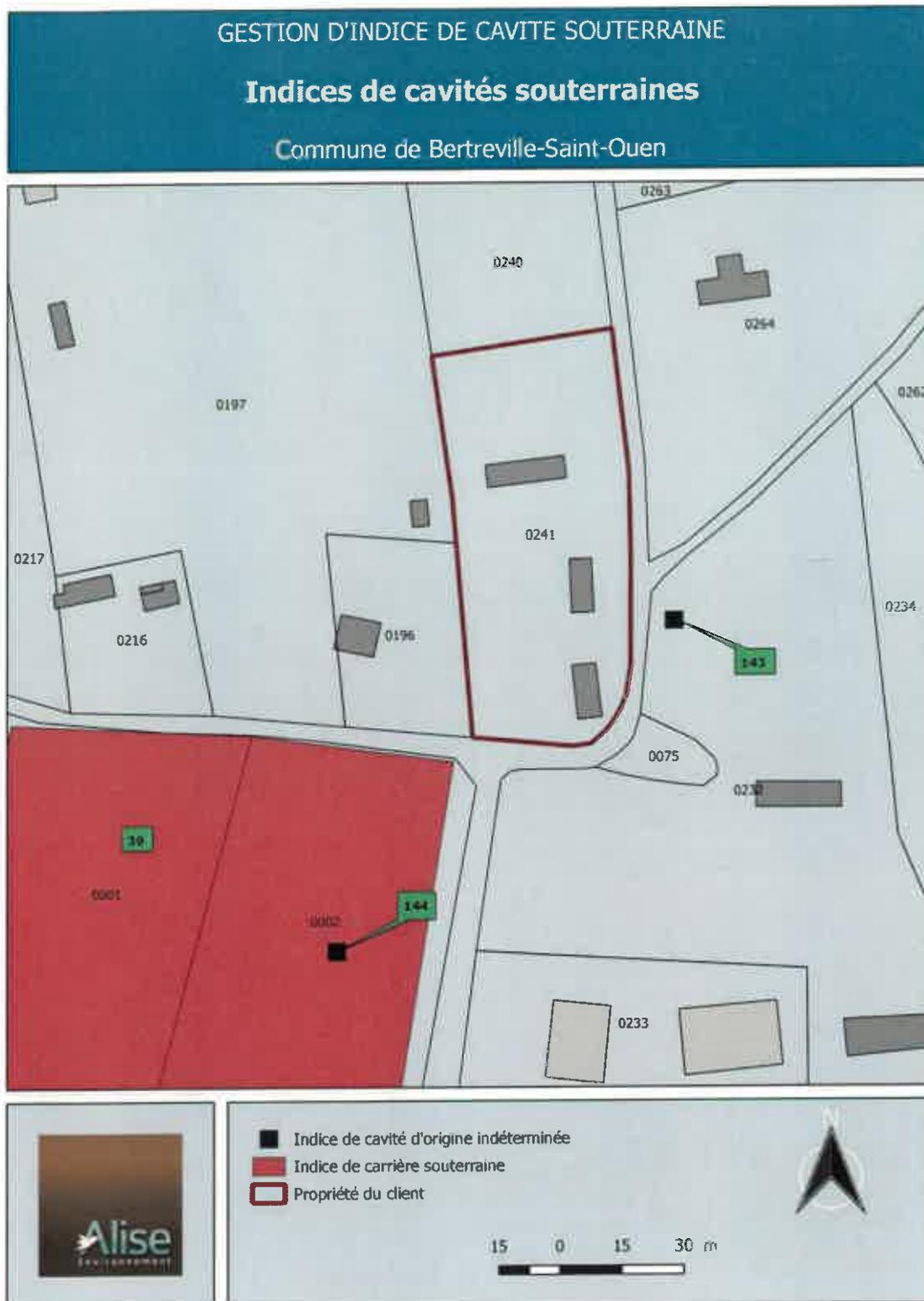
**Figure 2 : Localisation des indices de cavités souterraines n°39 et 143**
