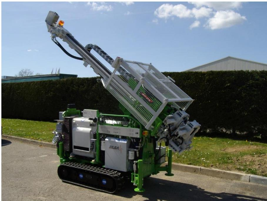
Les forages ont été réalisés en diamètre 110 mm, c'est-à-dire supérieur au diamètre minimal à mettre en œuvre dans le cadre de la recherche de cavités souterraines pour un indice lié à une parcelle Napoléonienne, afin de respecter les prérogatives des services de l'État.
