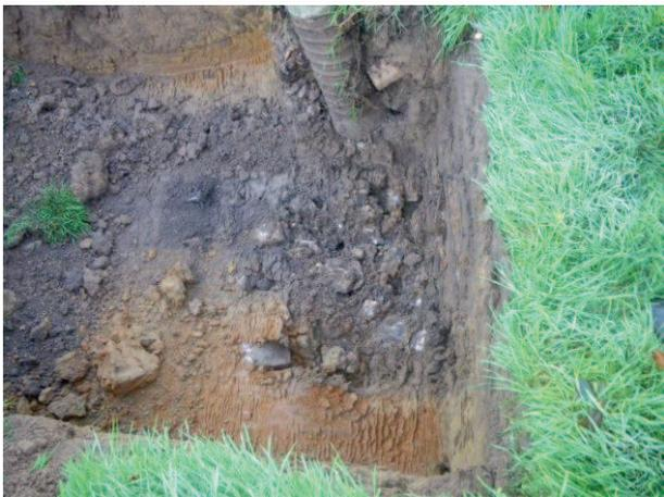
**Photographie 4 : les remblais restent présents jusqu'à 1,5 m de profondeur**
