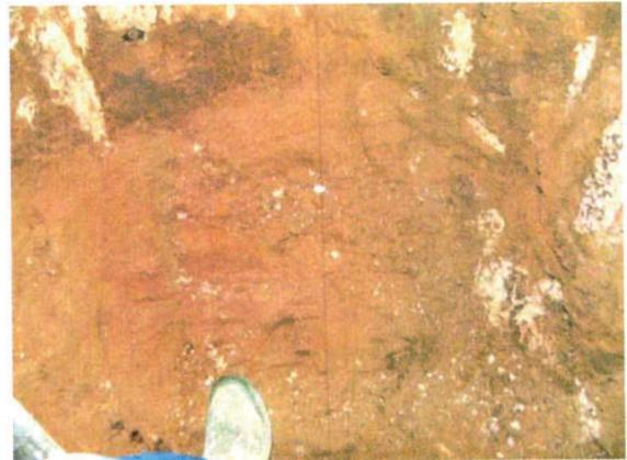
**Photographie 3 : Limon sur 3m présent dans le fond du puits**
