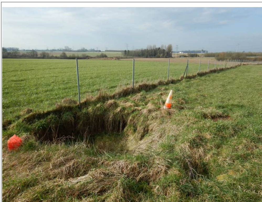
5. Illustration: Effondrement puits marnière SAPN 26
