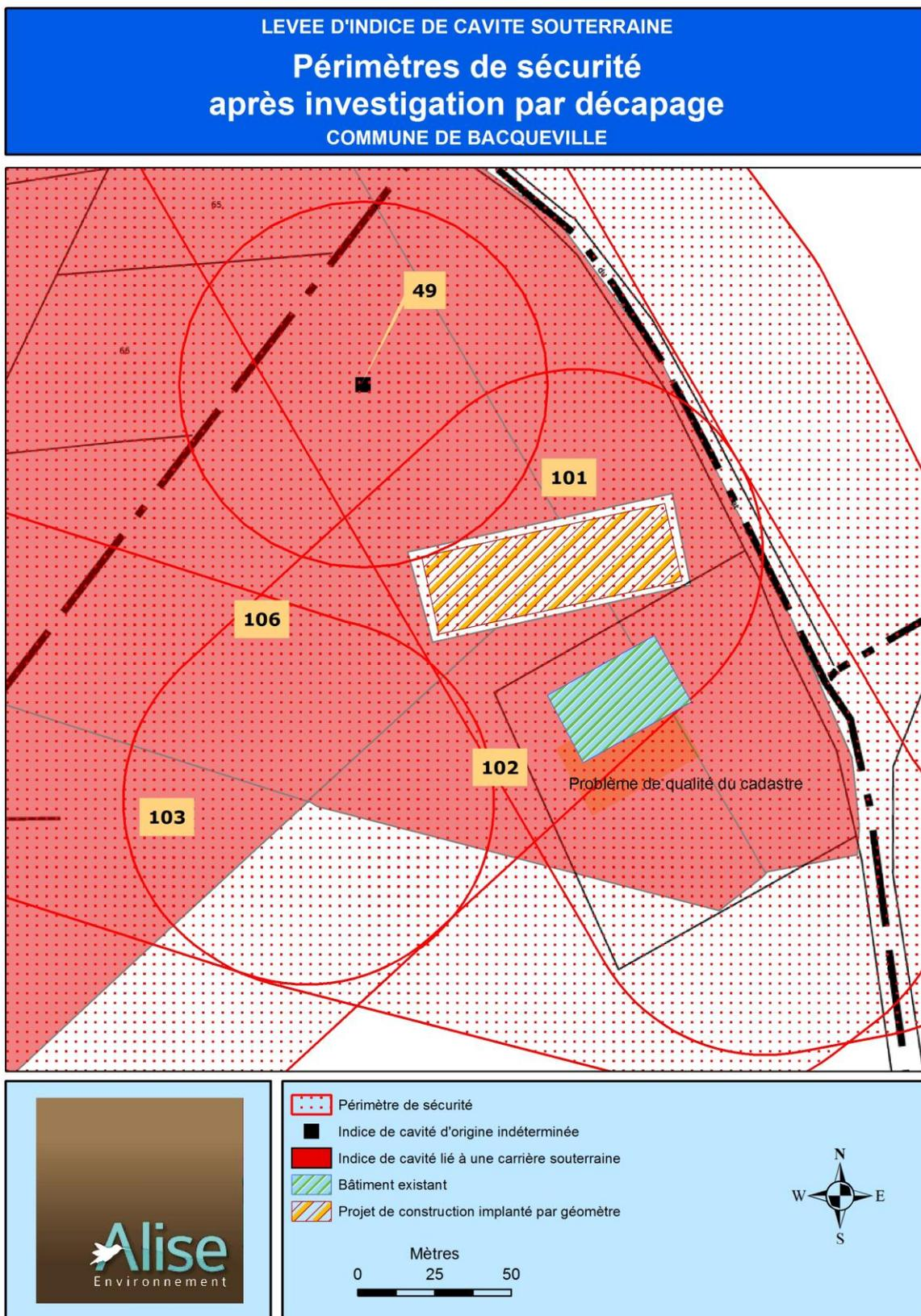
**Figure 7 : Périmètre de sécurité du puits (60 m)**
