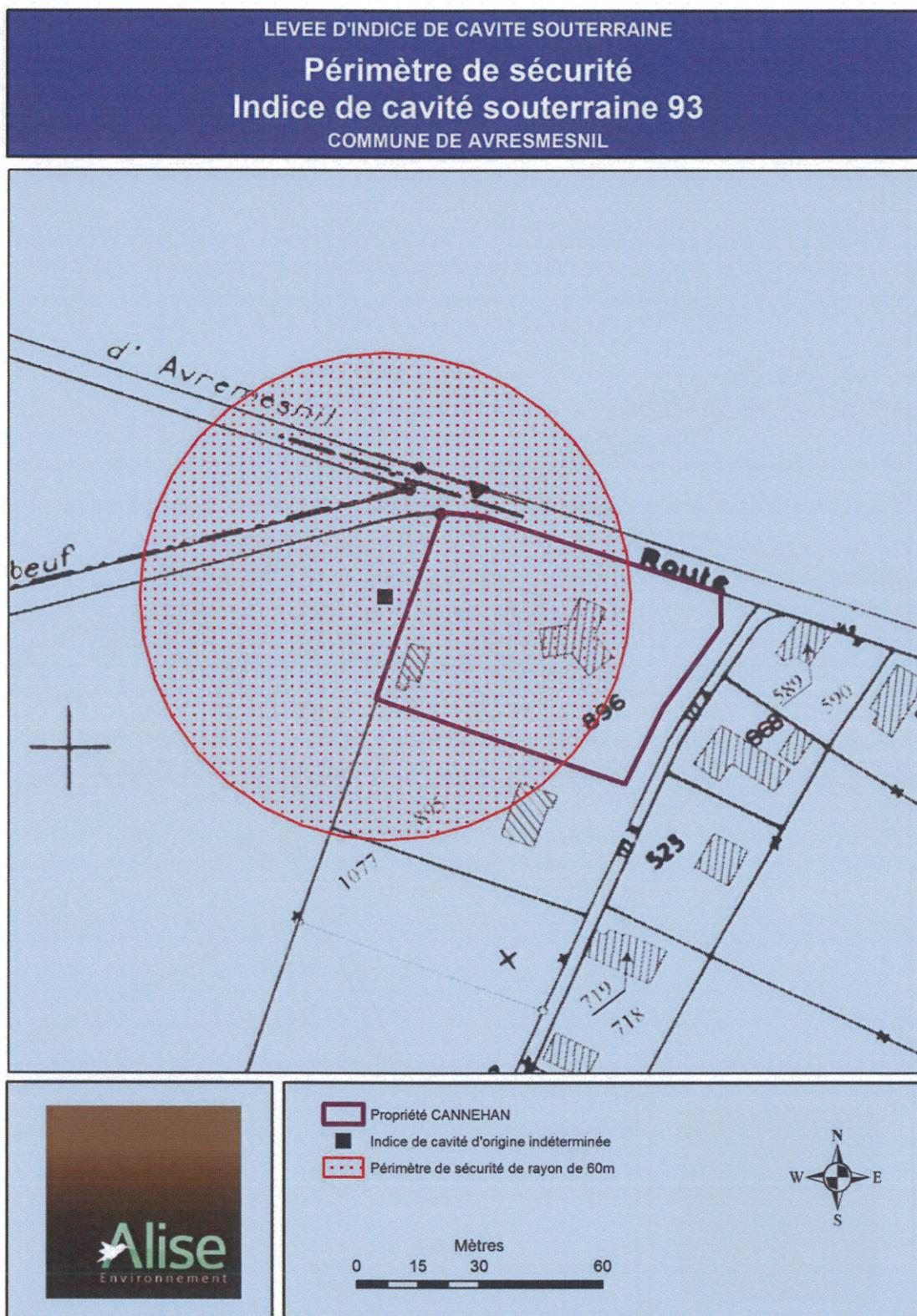
**Figure 3 : Indice de cavité souterraine n°93 et son périmètre de sécurité**
