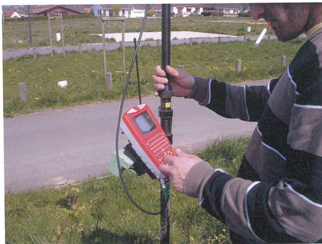
Relevé au DGPS de l'emplacement d'implantation des forages
