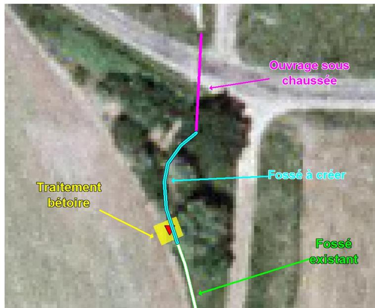
Schéma de principe des travaux
