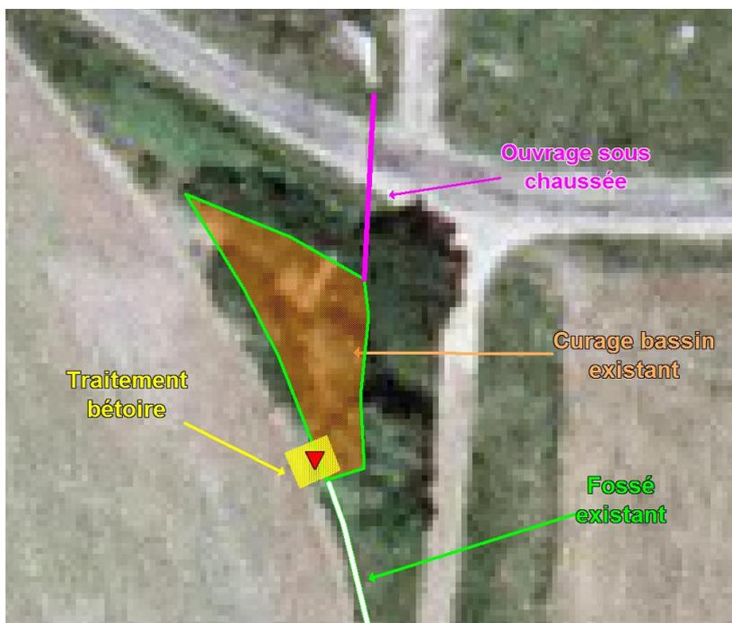
Schéma de principe des travaux
