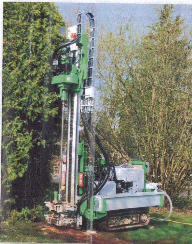
Les forages ont été réalisés en diamètre 102 mm. Nous rappellerons que le diamètre minimal à mettre en œuvre dans le cadre de la recherche de cavités souterraines afin de respecter les prérogatives des services de l'État est de 89 mm.
