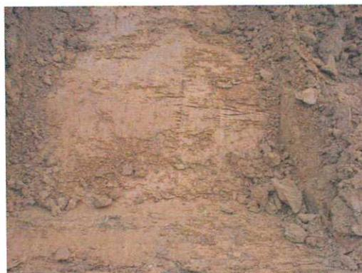
*Photo n°5* : Observation du terrain naturel limoneux (non remanié) sous l'épaisseur des différentes zones de remblai .
