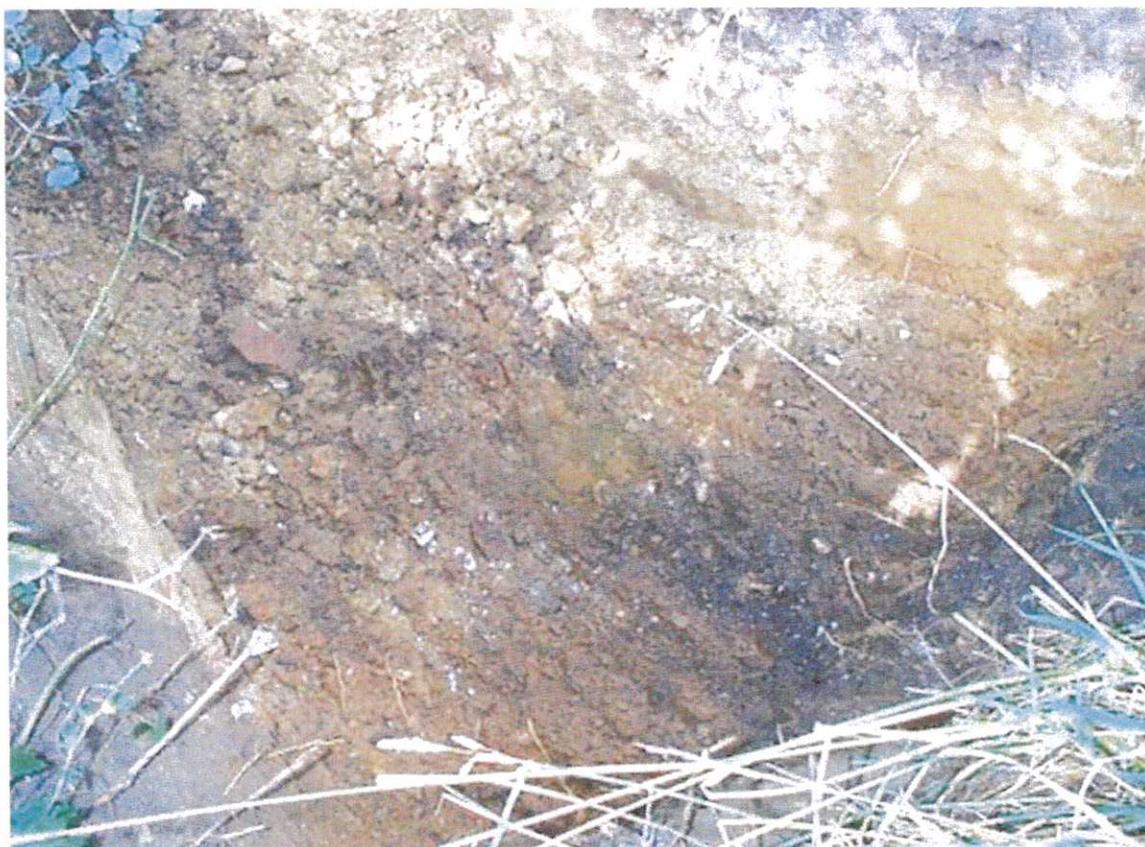
Photo 4: Sondage en pelle en cours sur l'indice 3 (cote -1.50m): remblai anthropique
