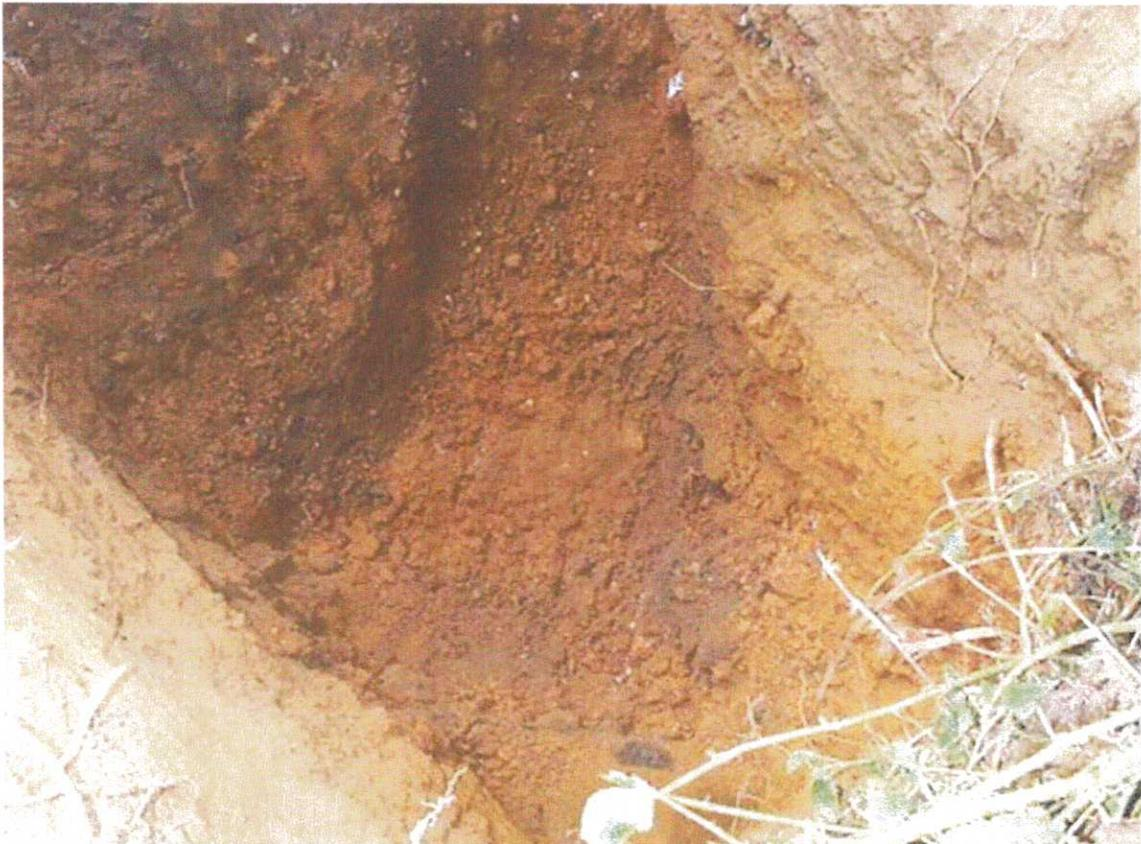
Photo 6: Fond de la fouille réalisée sur l'indice 3 (cote -3.00m): argile à silex, terrain en place
