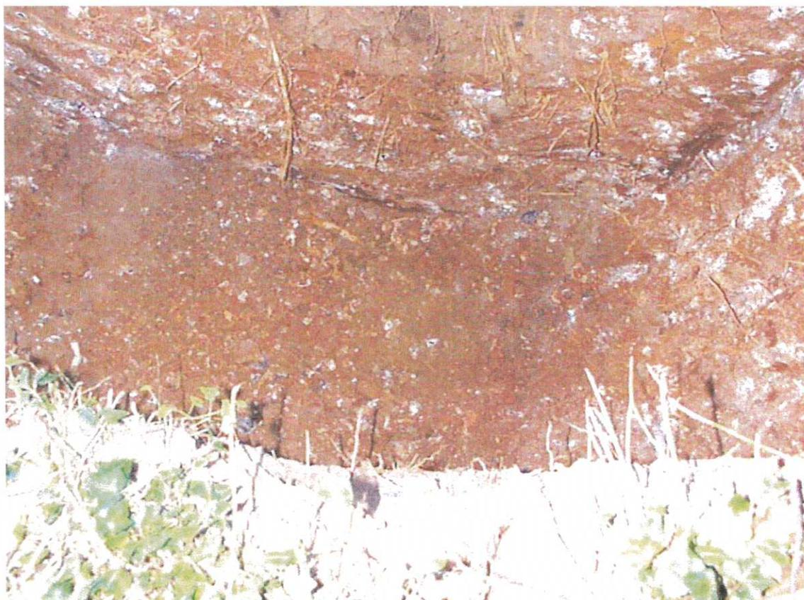
Photo 8: Fond de la fouille réalisée sur l'indice 92 (cote -3.00m): argile à silex, terrain en place
