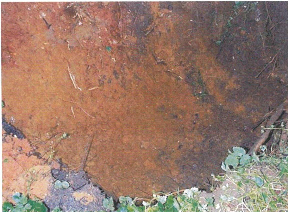
Photo 2: Fond de la fouille réalisée sur l'indice 43 (cote -2.00m): pas de remblai anthropique
