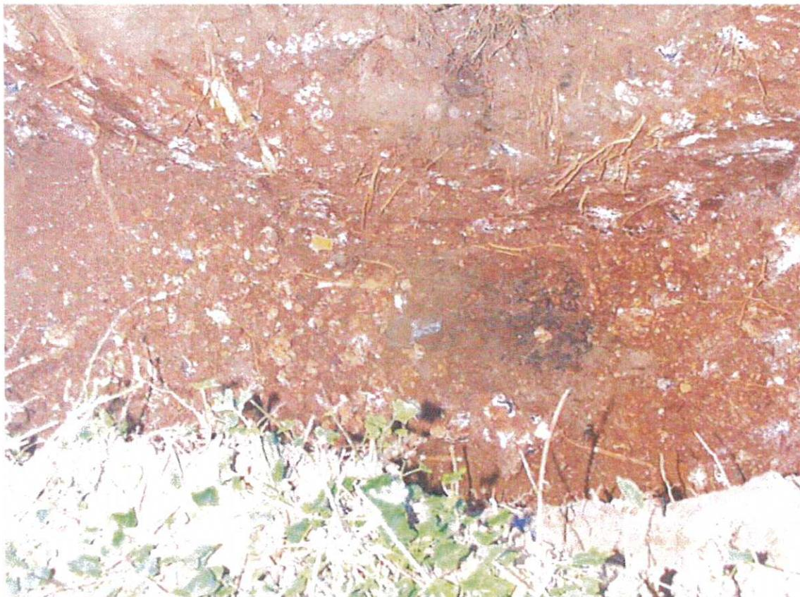
Photo 7: Sondage pelle en cours sur indice 92 (cote -2.00m): poche limons gris + terre végétale, diamètre 1m
