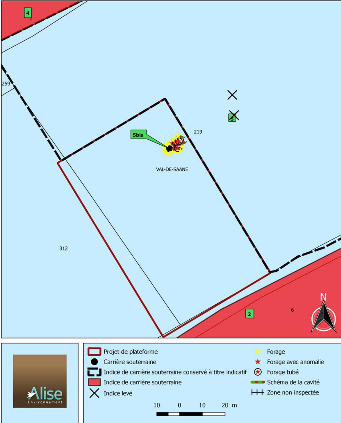
**Figure 9 : Proposition de relocaliser l'indice n°5 au droit de la cavité découverte**
