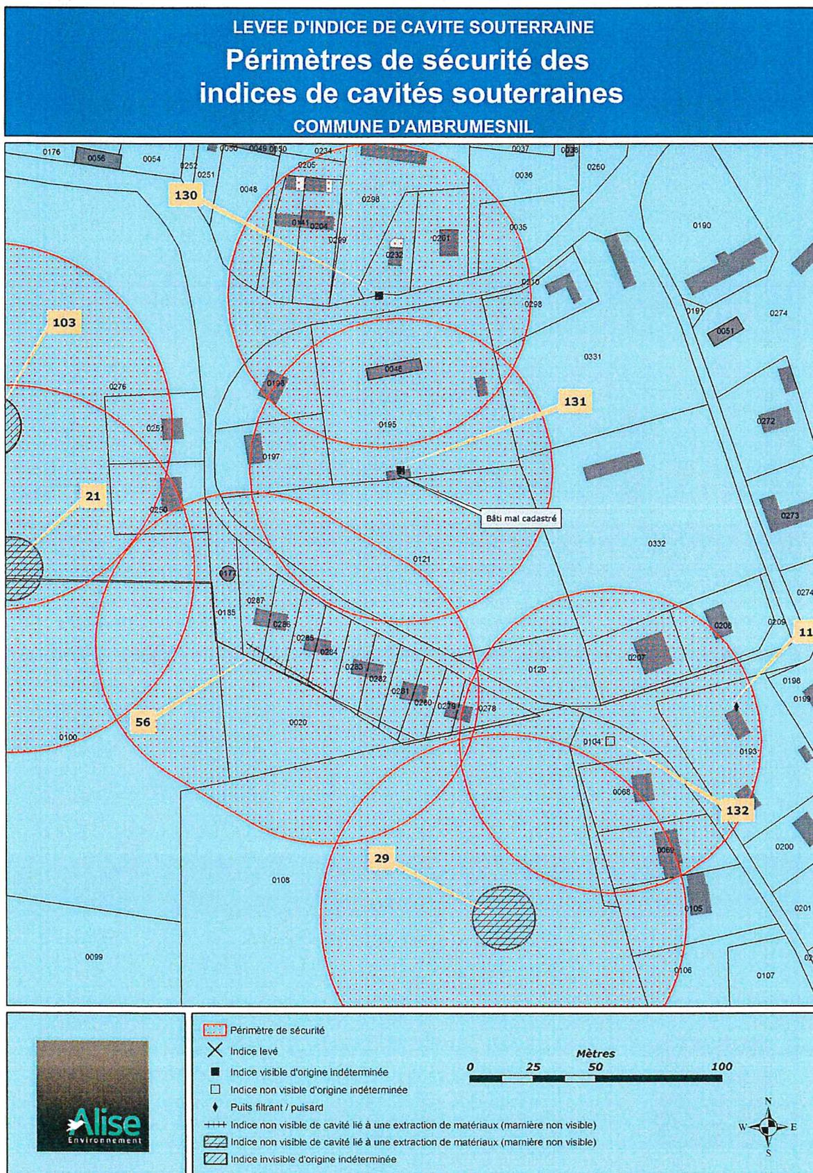
Figure 3 : L'indice de cavité souterraine et son périmètre de sécurité
