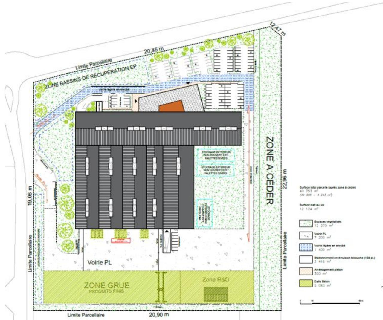
Figure 13 : Plan de masse du projet d'usine de refroidissement
